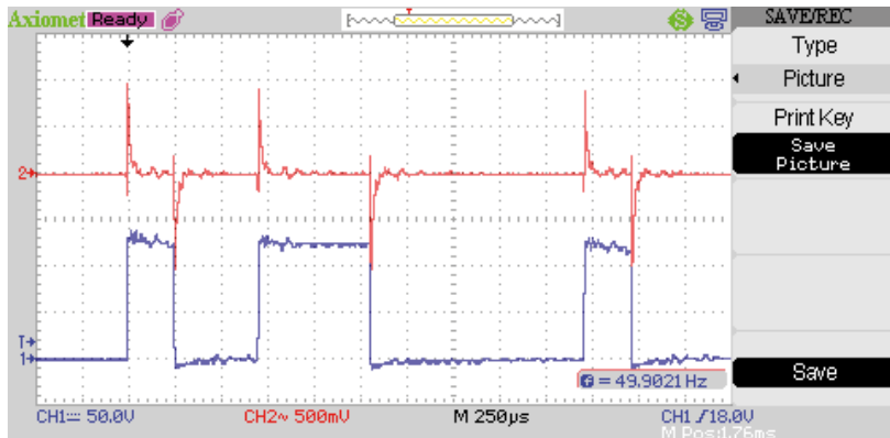
18. ábra. Egy piezokristályos porlasztó vezérlése egy fő impulzussal és egy-egy elő- illetve utóimpulzussal
