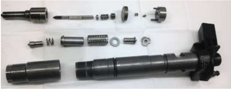
1.a ábra. A piezokristályos befecskendező alkatrészei.
